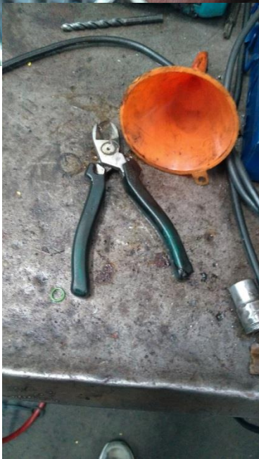
8.knijptang kan tie rips door knippen of bedrading knippen.
